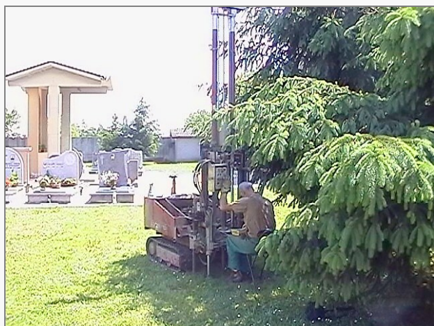
Esecuzione prove penetrometriche Cpt 1
